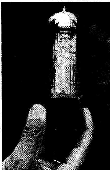
Fig. 5. Een geïntegreerde schakeling uit de jaren rond 1928: de 3NF combinatiebuis van Loewe welke drie trioden met de daartussen noodzakelijke koppelcomponenten verenigde binnen één glazen ballon. De gefotografeerde 3NF behoort tot de verzameling van P.AoAObE; de bereidwillige hand is van P.AoCSC. (Foto: P.AoSE).
